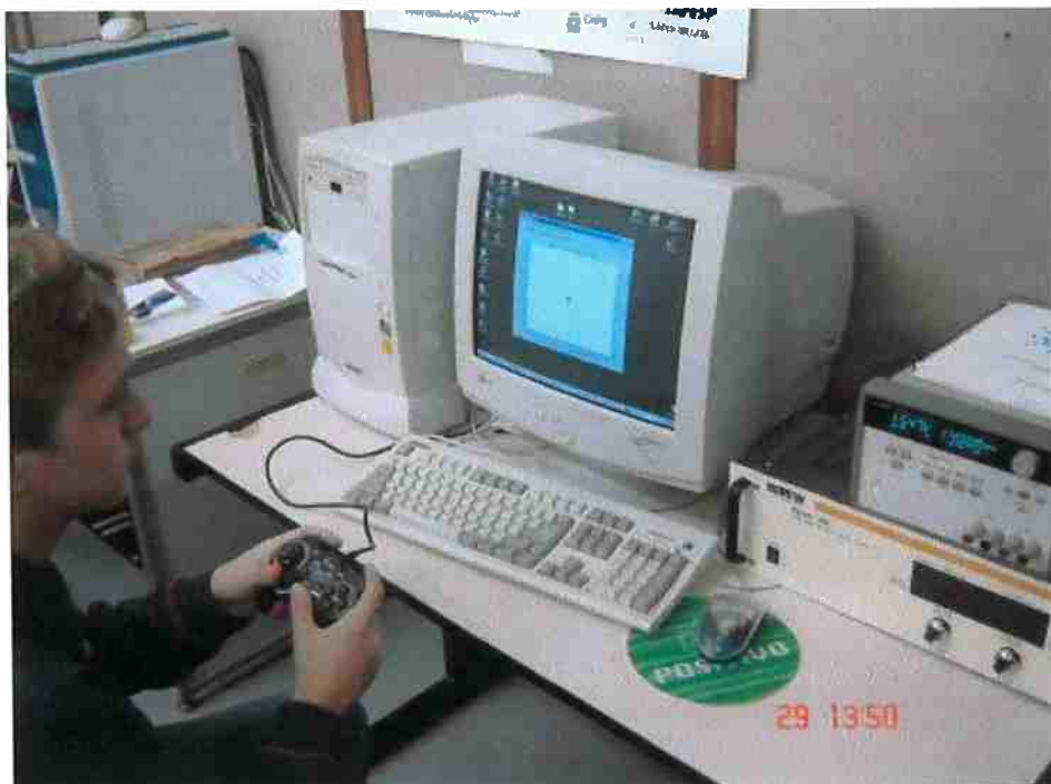
Figura 5.13 - Controle via Joystick da fonte de tensão
