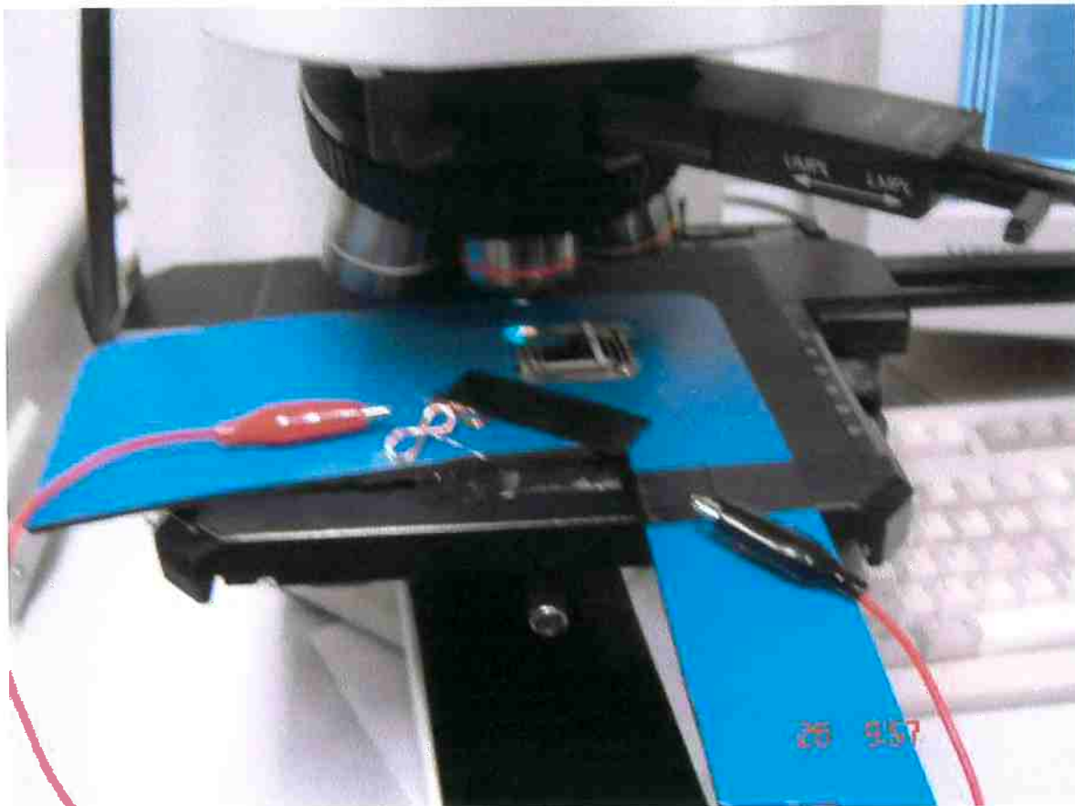
Figura 5.11 - Microscópio e suporte adaptado para testes com o atuador
